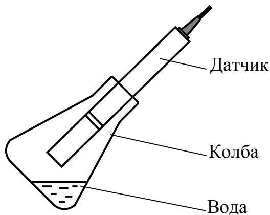
*Рисунок 2.4 – Положение датчика в колбе при градуировке прибора*
