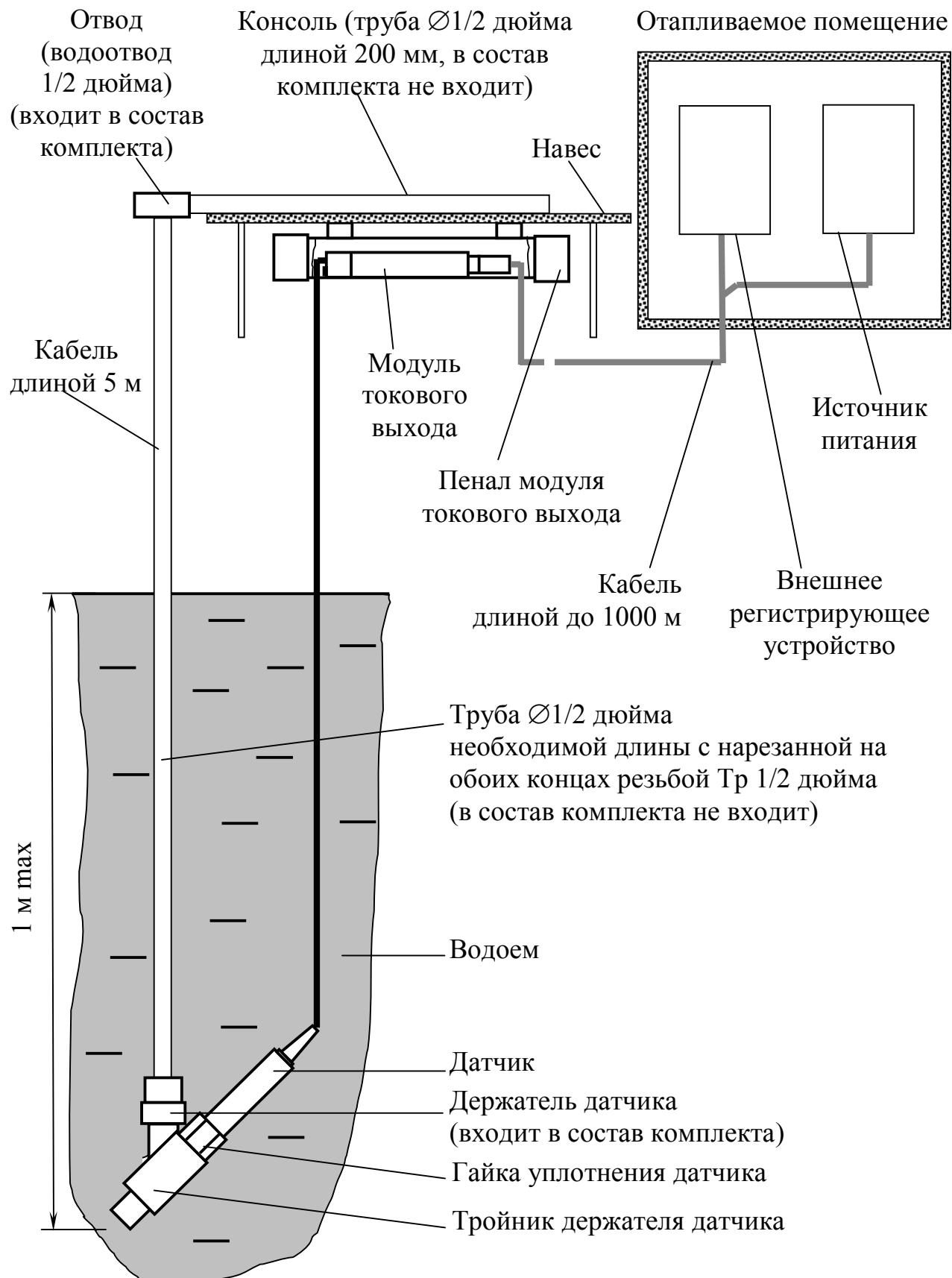
*Рисунок 2.6 – Условная схема размещения составных частей датчика кислородного*
