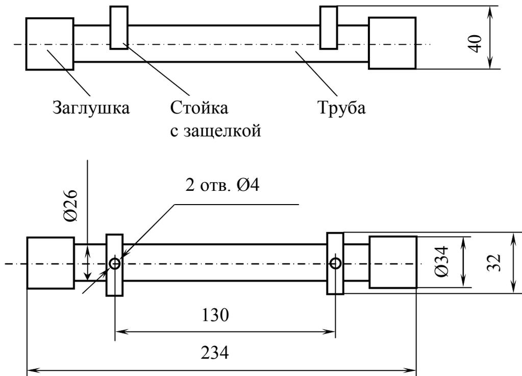
Рисунок 2.5 – Габаритные и присоединительные размеры пенала модуля токового выхода
