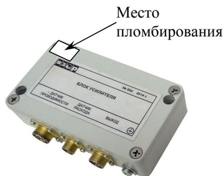
Рисунок 3 - Блок усилителя
